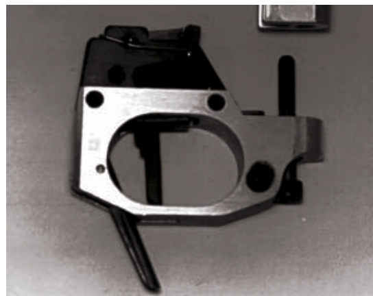
le mécanisme de détente
