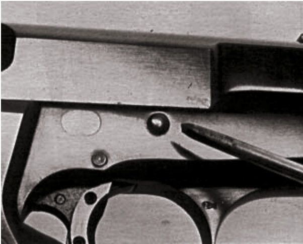
Pousser avec le doigt la saillie de la clavette d'assemblage indiquée par le tournevis
