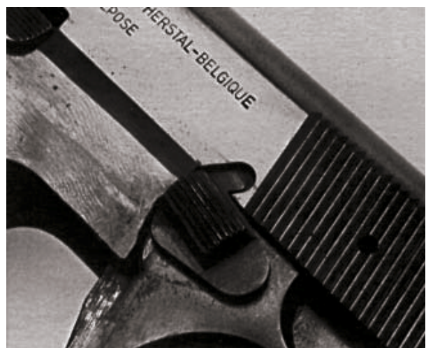
Verrouiller la glissière en position arrière avec la sûreté
