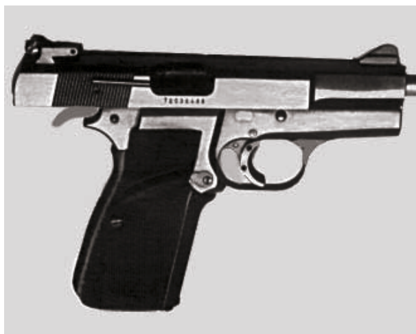
Amener la glissière en arrière au point maximum de course
