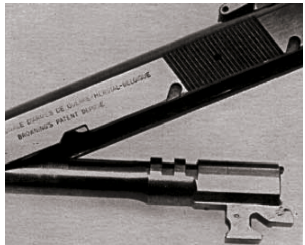
Faire basculer le canon vers le bas et dégager vers l'arrière
